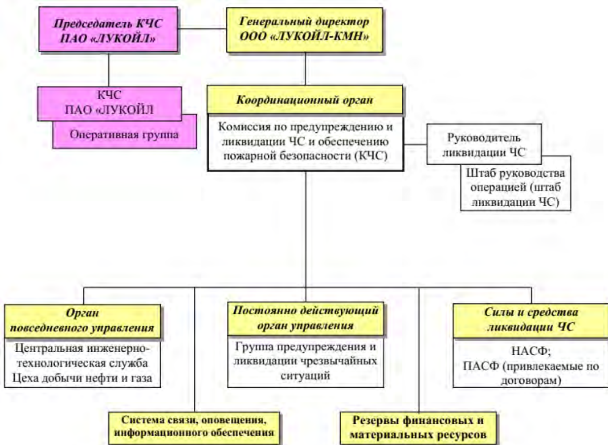
Рисунок 17 - Организационная структура функционирующей в ООО «ЛУКОЙЛ-КМН» системы предупреждения и ликвидации ЧС
