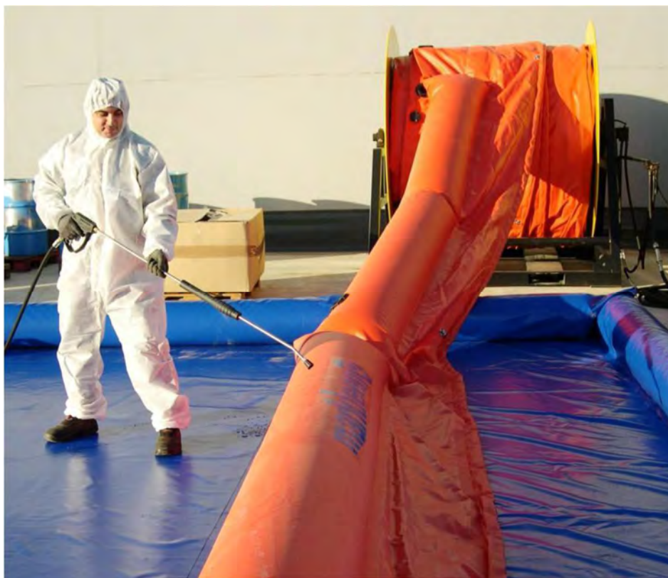
Обмыв бонов в надувной емкости при помощи моеющего устройства высокого давления
