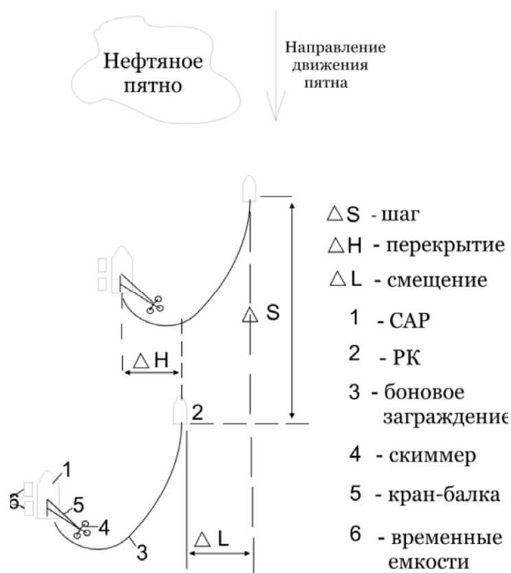
Рисунок 15. Мобильный ордер для эффективного сбора нефти
