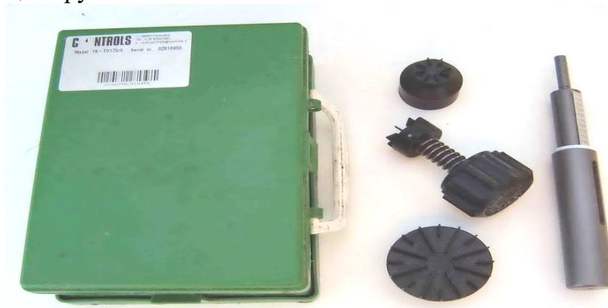
Рисунок 5.9 – Средства для экспресс-испытаний глинистых грунтов
