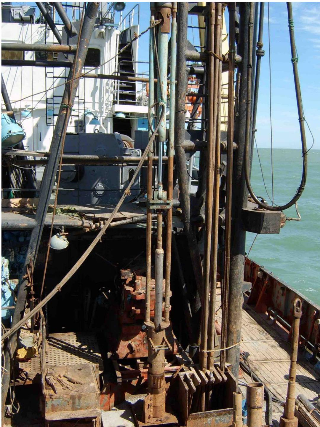
Рисунок 4. Устройство пробоотбора (методом вдавливания)
