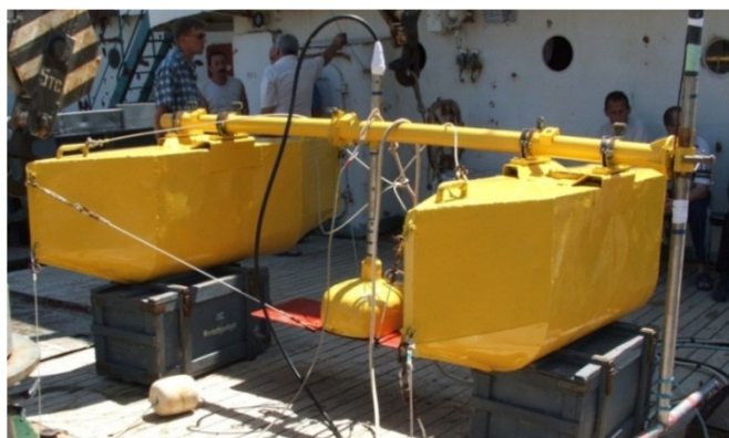
Забортное устройство для буксировки приёмоизлучающих компонентов "Boomer"
