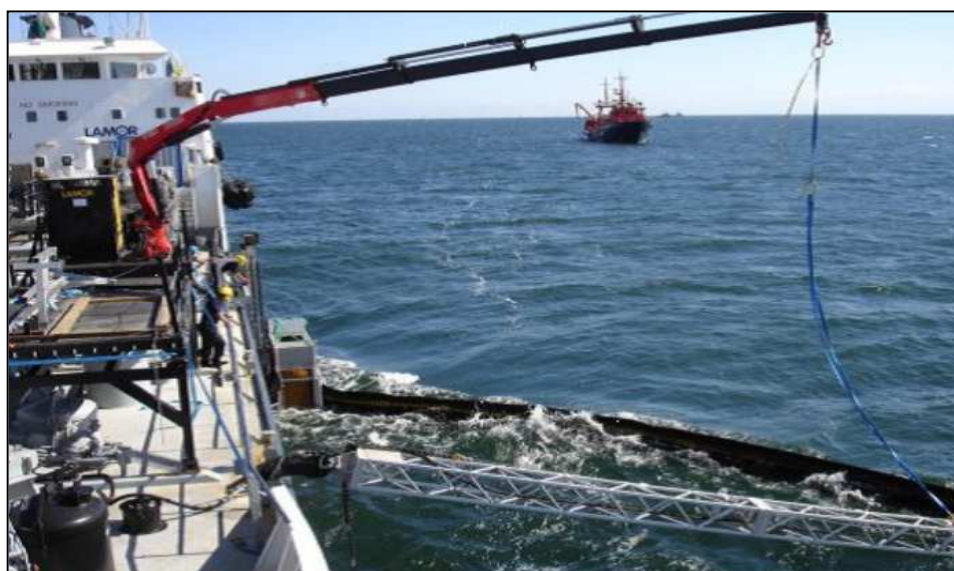
Рисунок 2.4 - Внешний вид нефтесборная системы «Lamog OPC-4»
