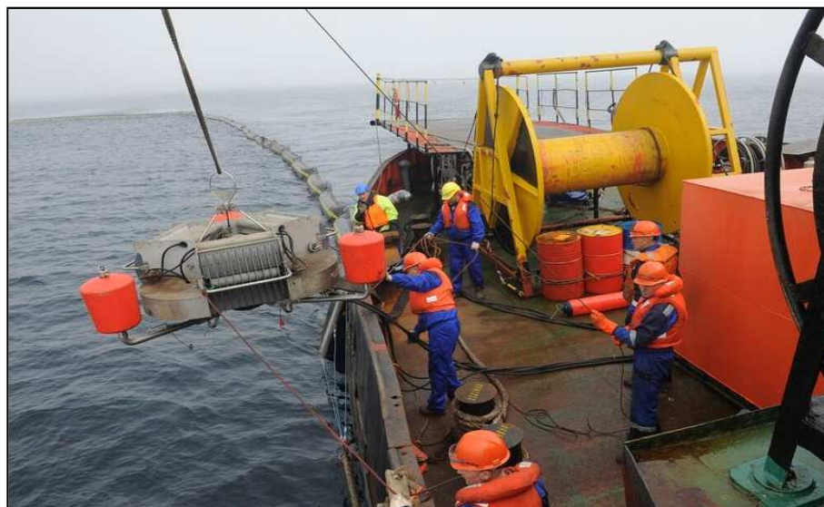
Рисунок 2.5 - Установка скиммера Desmi DBD в море
